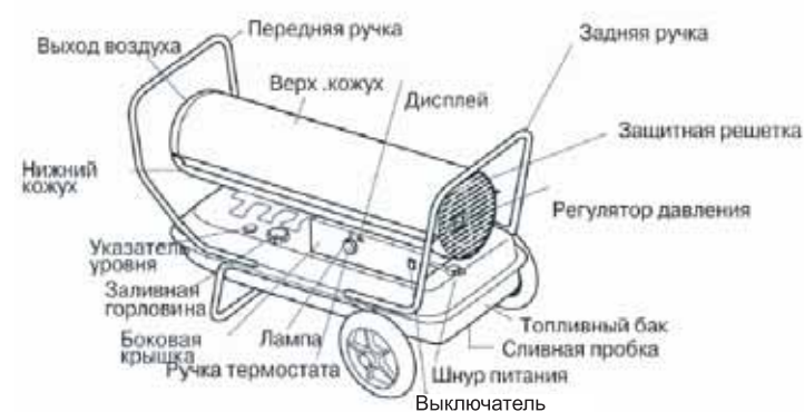
Рис. 6 Особенности моделей TK-30000, TK-50000 TK-70000, TK-100000
